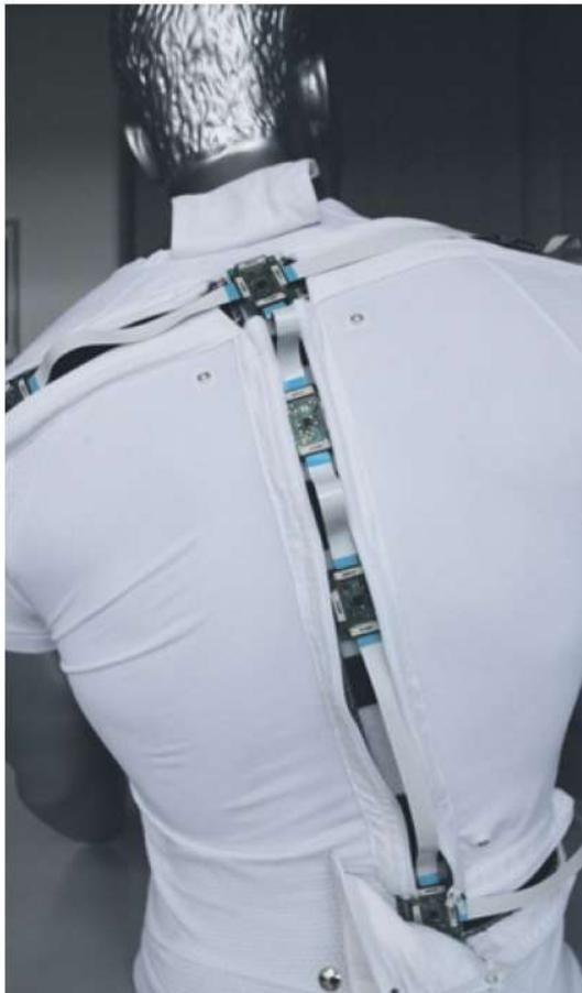
Zur elektronischen Erfassung der Körperhaltung wurde eine in die Dienstkleidung integrierte Sensorik (Sensorshirt) entwickelt. Aus deren Messwerten können konkrete pflegerische Maßnahmen abgeleitet werden. Foto: Fraunhofer IES
